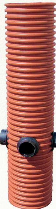
Дренажные колодцы адаптированы для присоединения к ним дренажных труб внешнего диаметра 110, 160, 200 мм, изготовленных компанией InstalPlast Łask с помощью защелкивающихся стаканов, установленных в уплотнении In-Situ. Снизу колодец можно (опция) закрыть пластиковым днищем с уплотнительным кольцом.
